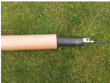
Sperrblase beim Einführen und Sperrblase aufgepumpt mit 1 – 1,5 bar
