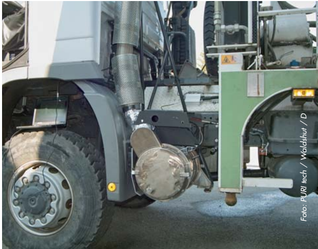
Erstmals auf der bauma stellt PURltech die weltweit ersten selbstreinigenden Filtersysteme für Dieselmotoren vor.
