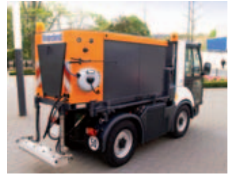
Das Schmalspurfahrzeug Tremo Carrier mit Epoke Solesprüher erreicht Streubreiten bis 3m. Auf der demopark wird erstmals der neue Multicar M 27 zu sehen sein. (Foto: Hako)
